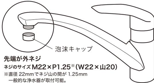
蛇口先端の泡沫キャップを外し、ハーレーⅡ付属部品 S コック(浄水と水道水の切替コック)を取り付けるため、先端が外ネジ (M22×P1.25) の水栓をお薦めします。
