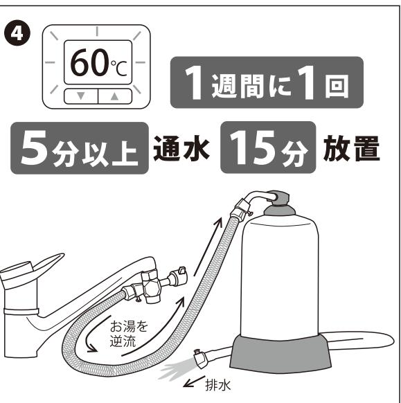
給湯温度を60°Cにセットします。Sコックを全開にします。水栓でお湯になるように水量を調節してください。
