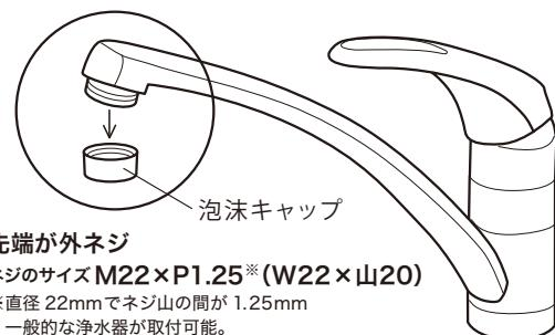
蛇口先端の泡キャップを外し、ハーレーⅡ付属部品Sコック(浄水と水道水の切替コック)を取り付けるため、先端が外ネジ(M22×P1.25)の水栓をお薦めします。
