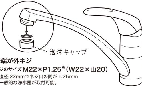
蛇口先端の泡沫キャップを外し、ハーレーⅡ付属部品Sコック(浄水と水道水の切替コック)を取り付けるため、先端が外ネジ(M22×P1.25)の水栓をお薦めします。
